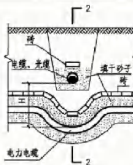
直埋电缆、光缆与电力电缆交叉图(二)
